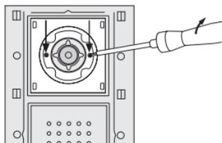
5. Fixieren Sie den Objektivträger, indem Sie beide Torx-Schrauben wieder anziehen.
