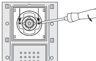
2. Lösen Sie die beiden Torx-Schrauben links und rechts neben dem Kameraobjektiv.
