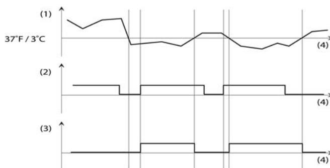
Bild 8: Vereisungsschutz in Abhängigkeit von Temperatur und Niederschlag
