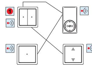
**i** Der Funk-Taster CONNECT 1fach erhält immer die Funktion der linken Taste des Systemverwalters.
