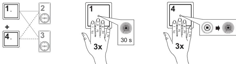
**Ergebnis:** Sie haben eine Wechselschaltung aufgebaut mit zwei Sendern (Taster) und zwei Verbrauchern.
